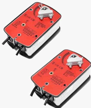
LFZ-T05系列电动风阀驱动器采用进口直流电机/无刷电机为该产品提供动力部分，可提供5NM的扭矩。该产品广泛的应用于建筑通风行业，能实现断电机机械复位，电动开启，提供30000次以上反复动作。
